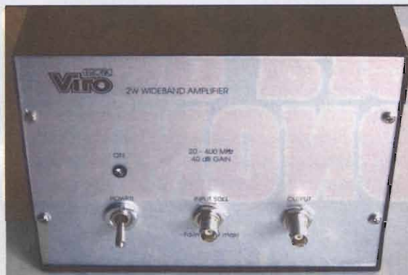
figura 8 - Pannello frontale dell'amplificatore, opportunamente incasellato. Le scritte sono stampate su una etichetta metallizzata della "Océ" per stampante laser.
