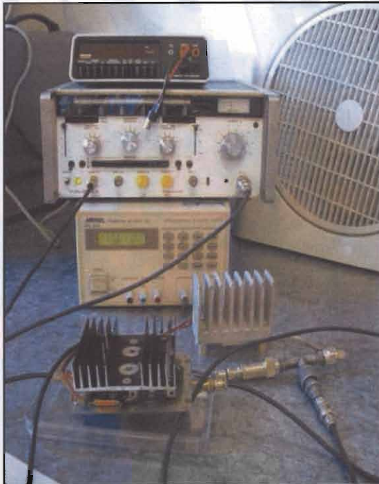
figura 7 - Valutazione della banda passante dell'amplificatore con CA2870 (in basso, con l'aletta nera). A destra sono presentati, in basso, lo schema di misura, e, in alto, il grafico ottenuto spazzolando da 0 a 550MHz. Nella zona piatta, tra 20 e 400MHz, la potenza di uscita varia non più di 1.5dB.
